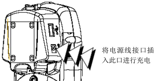
将电源线接口插入此口进行充电
